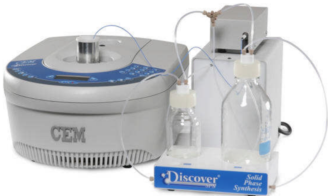
Abb. 2: CEM Discover mit Spezialausrüstung für die Festphasen-Peptid-Synthese nach Merrifield
