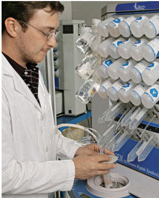
Abb. 3: Dualer Peptid-Synthesizer Liberty im Einsatz: Wahlweise mit Mikrowelle oder ohne Mikrowellenaktivierung
